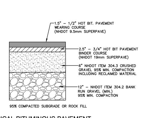
TYPICAL BITUMINOUS PAVEMENT
