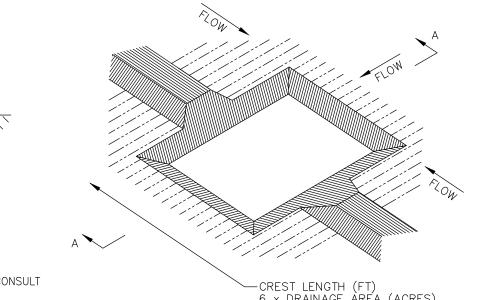
6 x DRAINAGE ÀREA (ACRES) SEDIMENT TRAP - ISOMETRIC VIEW
