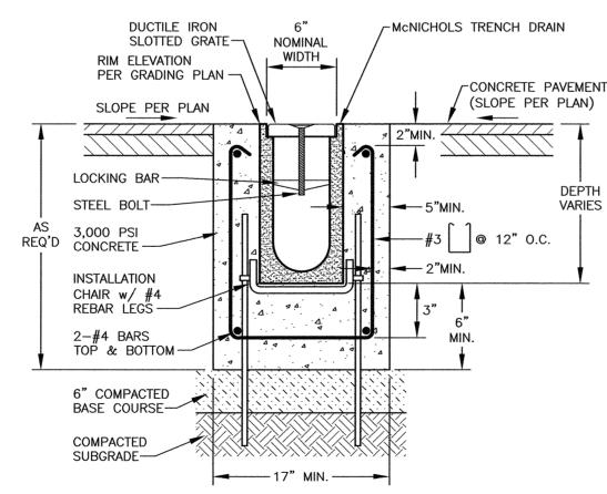
EVAPORATIVE TRENCH DRAIN DETAIL IN GARAGE
