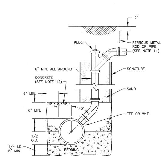
NO BACKFILLING BEFORE CONCRETE HAS TAKEN INITIAL SET (7 HRS. MIN.). BACKFILLING TO BE BROUGHT UP EVENLY ON ALL SIDES.
