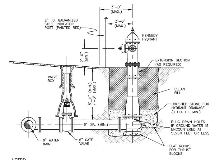
1) HYDRANTS SHALL BE INSTALLED A MAXIMUM DISTANCE OF 3 FEET CURB LINE TO OPERATING NUT. 2) THE PUMPER OUTLET NOZZLE SHALL FACE THE STREET. ) CENTERLINE OF NOZZLES SHALL BE A MINIMUM OF 2 FEET ABOVE FINISHED GRADE OF STREET. 4) AREA AROUND HYDRANT SHALL BE GRADED TO ALLOW ANY SURFACE WATER TO DRAIN AWAY FROM
